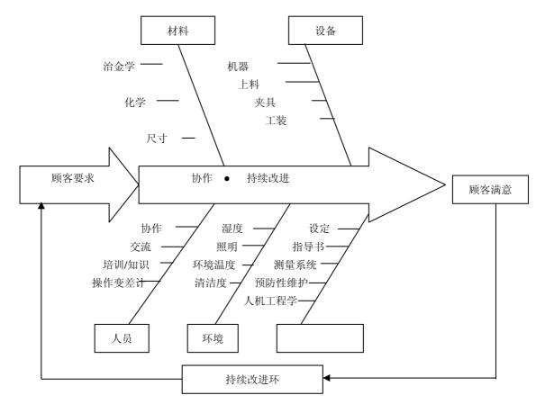
图 1 将过程类型组织为原因和后果模型,其中第一级的分类为:人员、材料、设备、方法和制度、环境。示例描述了使用相应的控制计划进行的制造和装配情况,以显示以下各页中所述的典型文件。成功地开发一个有效利用成本的过程的关键是识别变差源和适当的控制方法。
